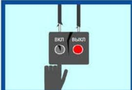
Прикосновение к токоведущим частям электроустановок, проводам, находящимся под напряжением.
