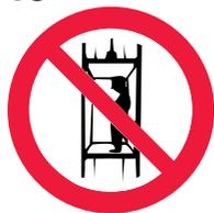
**Запрещается подъем (спуск) людей по шахтному стволу (запрещается транспортировка пассажиров)**
