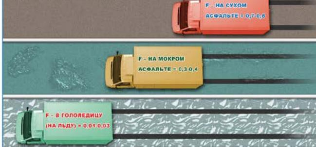
Коэффициент сцепления колес автомобиля с дорогой  $f = P_{tr} / P_k$ , где  $P_{tr}$  – сила трения скольжения колес с дорогой,  $P_k$  – вес автомобиля, приходящийся на его колеса
