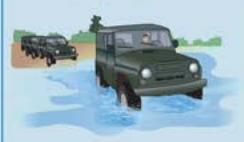
Глубина воды не должна превышать допустимую для данного автомобиля. При этом надо учитывать, что в грунте на дне может образоваться колея, в которую углубится автомобиль, и погружение его в воду возрастает, а также учесть, что понижение давления воздуха в шинах до нормы предела также приводит к его углублению в воду. Необходимо иметь в виду, что впереди автомобиля поднимается волна, которая также повышает уровень воды в шине двигателя.
