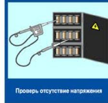
Проверь отсутствие напряжения
